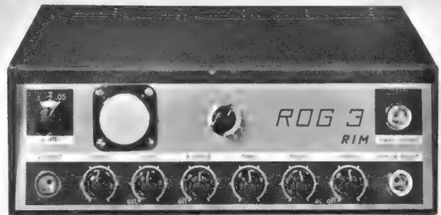
Bild 1. Der Kleinstoszillograf ROG 3 (Radio-RIM) im Flachgehäuse. Die Abmessungen betragen nur 25,5 cm  $\times$  9,5 cm  $\times$  18 cm
