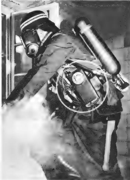
Bild 4. Im Kreis: Notsignalgeber für Feuerwehr- und Rettungsleute. Ein- bis zweimal pro Minute muß der Träger den Geber durch einen Ellenbogenstoß „beruhigen“, anderenfalls stößt er gellende Hilfsignale aus
