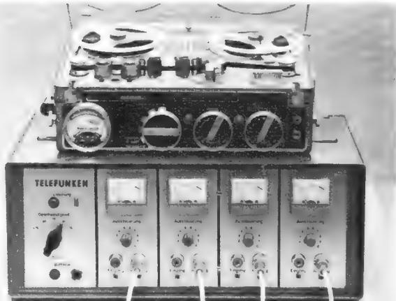
Bild 8. Magnetband-Analogspeicher MAS 54 mit vier Kanälen für Frequenzmodulation und -demodulation mit dem kommerziellen Magnetbandgerät Nagra III
